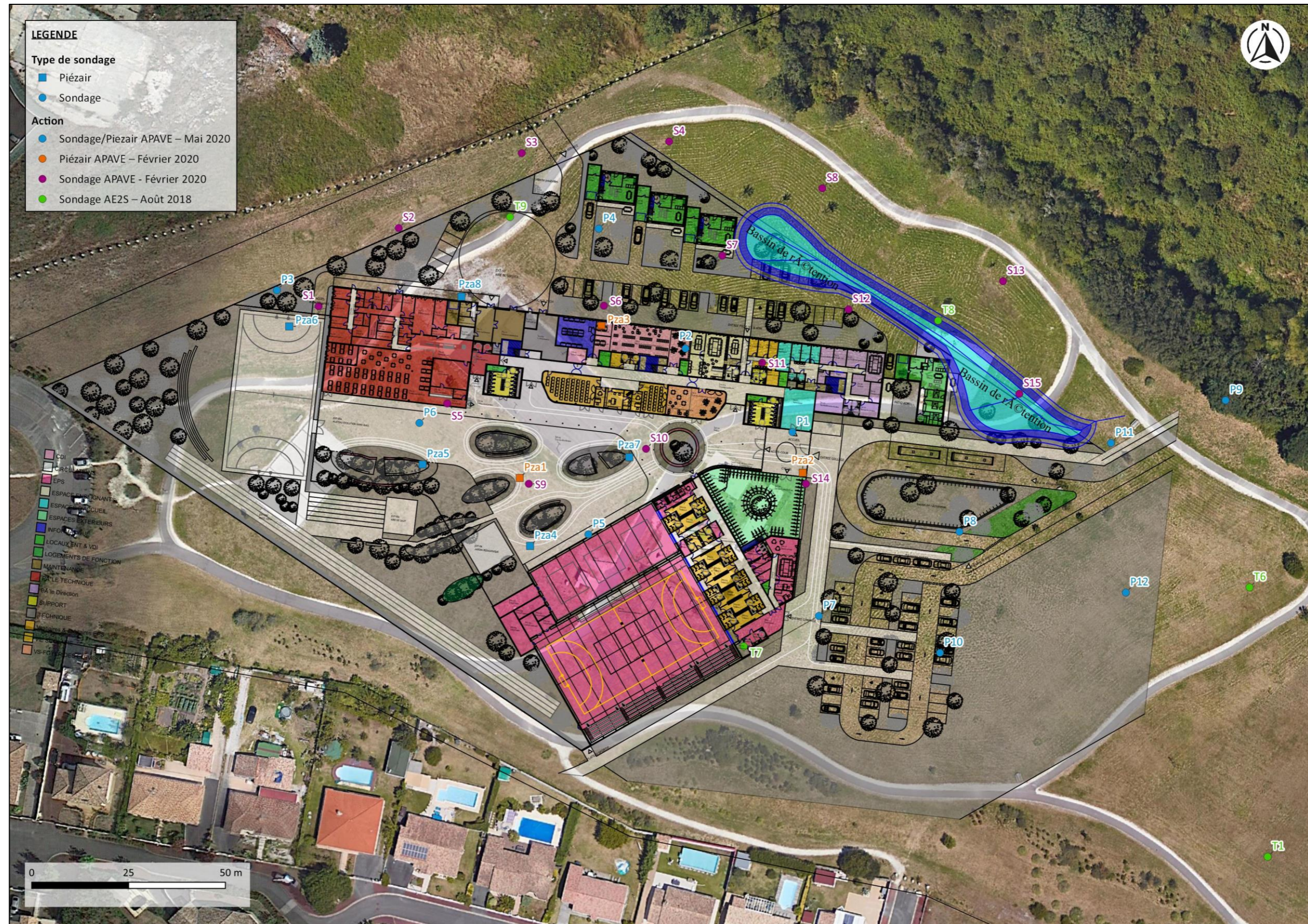
Figure 7 : Plan de synthèse des sondages réalisés sur le plan de masse du futur collège (Source du projet d'aménagement : EDEIS – mail du 26/04/2021)
